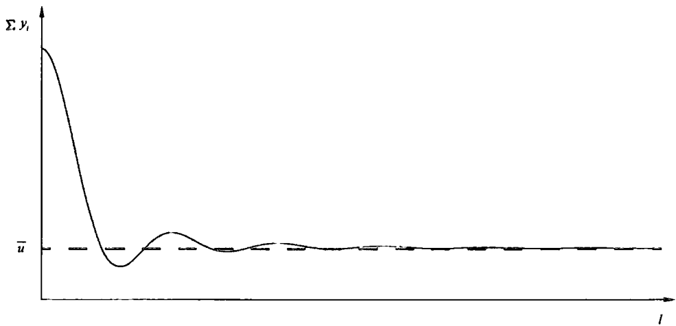
图 2 压力信号均值随信号序列长度变化图
